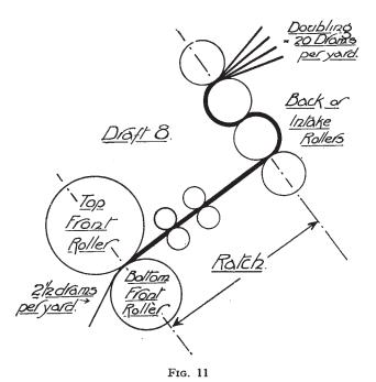
ELEVATION OF DRAWING BOX ROLLERS
