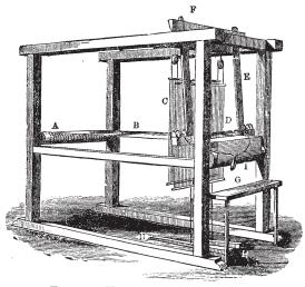
FIG. 14. -KAY'S FLYSHUTTLE LOOM
