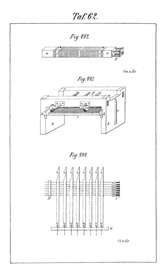
Die Jacquardmaschine wird nach der Anzahl Platinen, welche sie enthält, benannt; so spricht man z. B. von 200er, 400er, 600er und dergleichen Maschinen und versteht darunter, dass eine 400er Maschine 400 und eine 600er Maschine 600 Platinen enthält. Die angewendetste Maschine ist die 400er.
