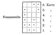
Hat man den Wechsel für Jacquard zu fertigen, so ist dies sehr leicht. Man hat nur dort Löcher in die Reserve oder in die sonst dazu benutzten Platinen zu schlagen, wo rechts und links ein Kasten gebraucht wird, also so, wie der Schützenlauf ist.
