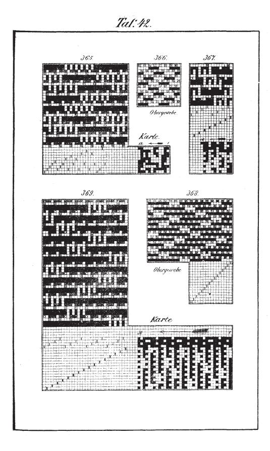
durch einander; die Schnürung b wird somit leicht verständlich, auch erkennt man die Einfachheit und Sicherheit in deren Ausarbeitung. Man vergleiche übrigens diese Schnürung mit dem, was oben über die Bewegung der Schäfte bei den Ober- und Unterschüssen angedeutet worden.
