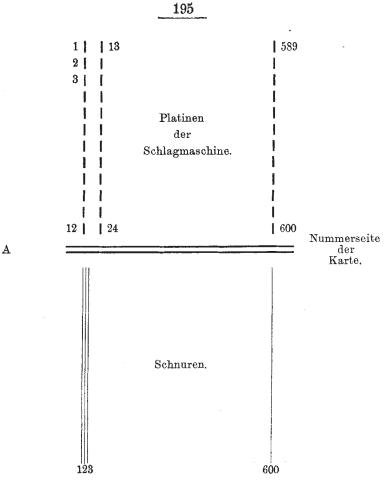
Bedenkt man, dass in den Spalt *A* das Pappblatt vertical eingelegt wird, so durchdrückt der Stössel der ersten Schnur das unterste Loch links, während der letzte Stössel rechter Hand das oberste Loch rechts der Karte durchstösst.
