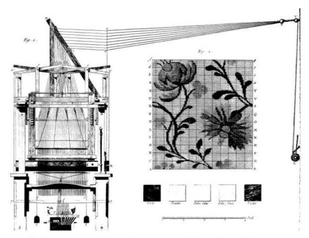
SOLETTE , Engiès Brochées , Elévation Géométralle du devant du Metter pour fabriquer les Étores Brochées
