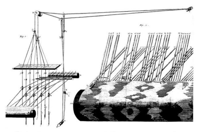
Solerie, Développement des cordes de Rame et de Sample et leur action sur les Fils de la Artine des Étypes Brochels ou le Poil des Velours, frizés et Coupés Bartie d'Étype Brochée Viu su coté de l'envers et au Microscope?
