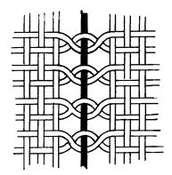
FIG. I. THE SIMPLEST FORM OF FILLING LENO
