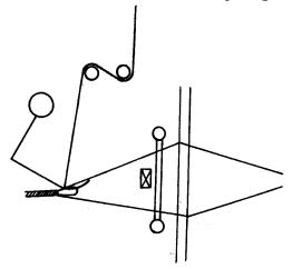
FIG. 15. SHOWING THE POSITION OF THE LOOPER AT THE SECOND PICK
